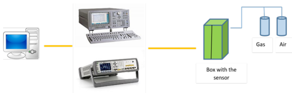
Рисунок 2. Установка измерения газочувствительных свойств сенсора.
