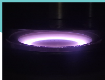
Рис 2. Плазма разряда ионов аргона в магнетроне используемая для синтеза алмазоподобных пленок модифицированных наночастицами различных металлов
